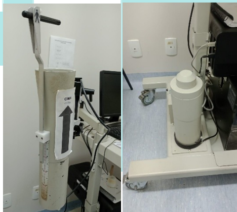
Figura 2 – Detectores: sonda (esquerda) e poço (direita)
