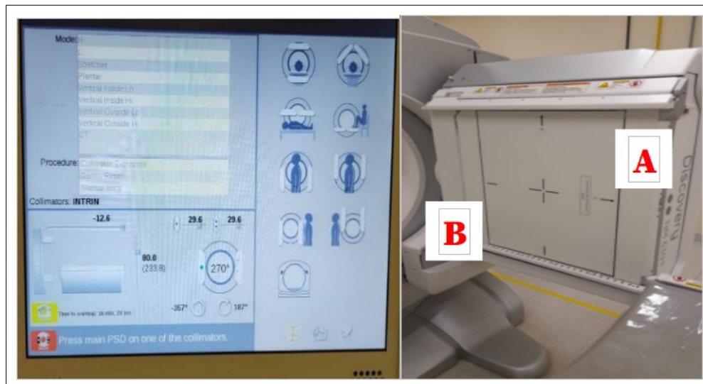
Figura 6 – Mensagem solicitando o pressionamento dos sensores PSD – esquerda. Sensores de pressão PSD dos colimadores/detectores – direita.
