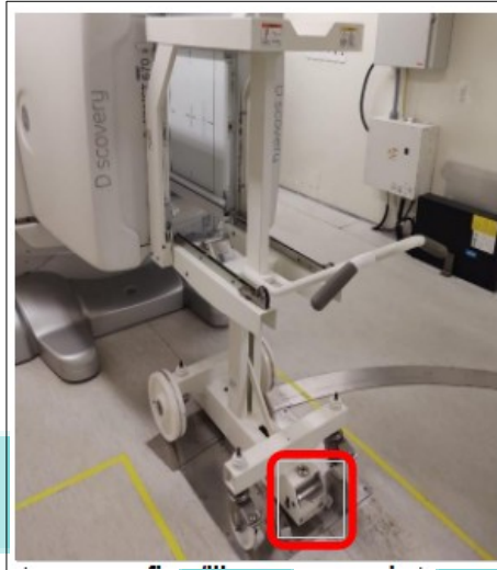
Figura 4 – A: traba para fixar/liberar o carro de transporte dos colimadores
