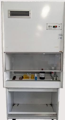
Figura 11: Cabine de segurança biológica do Laboratório de Patologia
