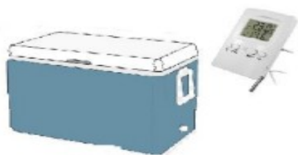
Figura 2. Caixa térmica com termômetro cabo extensor.
